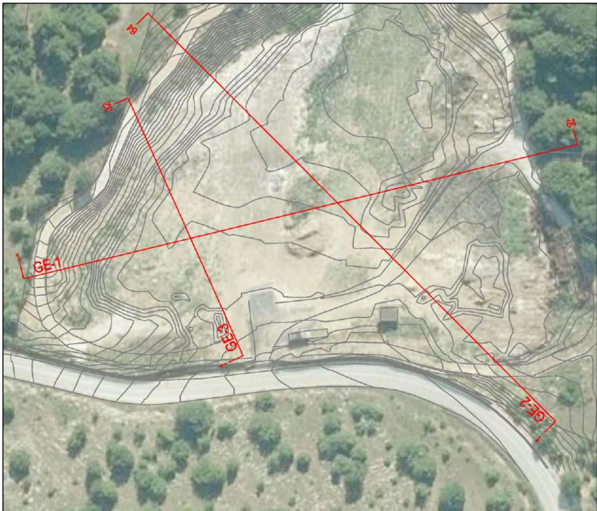
Slika 2.2.-2. Situacijski prikaz izvedenih profila geoelektrične tomografije
